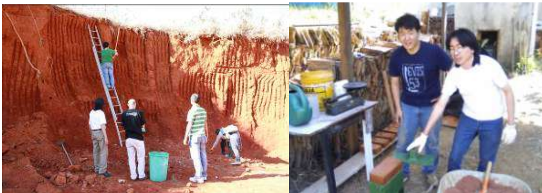
Figura 12 – (Esq.) Voluntários da Associação Keppe e Pacheco extraem terra para produção de tijolos de solo-cimento para ensaios na empresa Pattrol de BH (Ago/2010). (Dir.) Tijolos de solo-cimento produzidos para envio para o ensaio acima.
